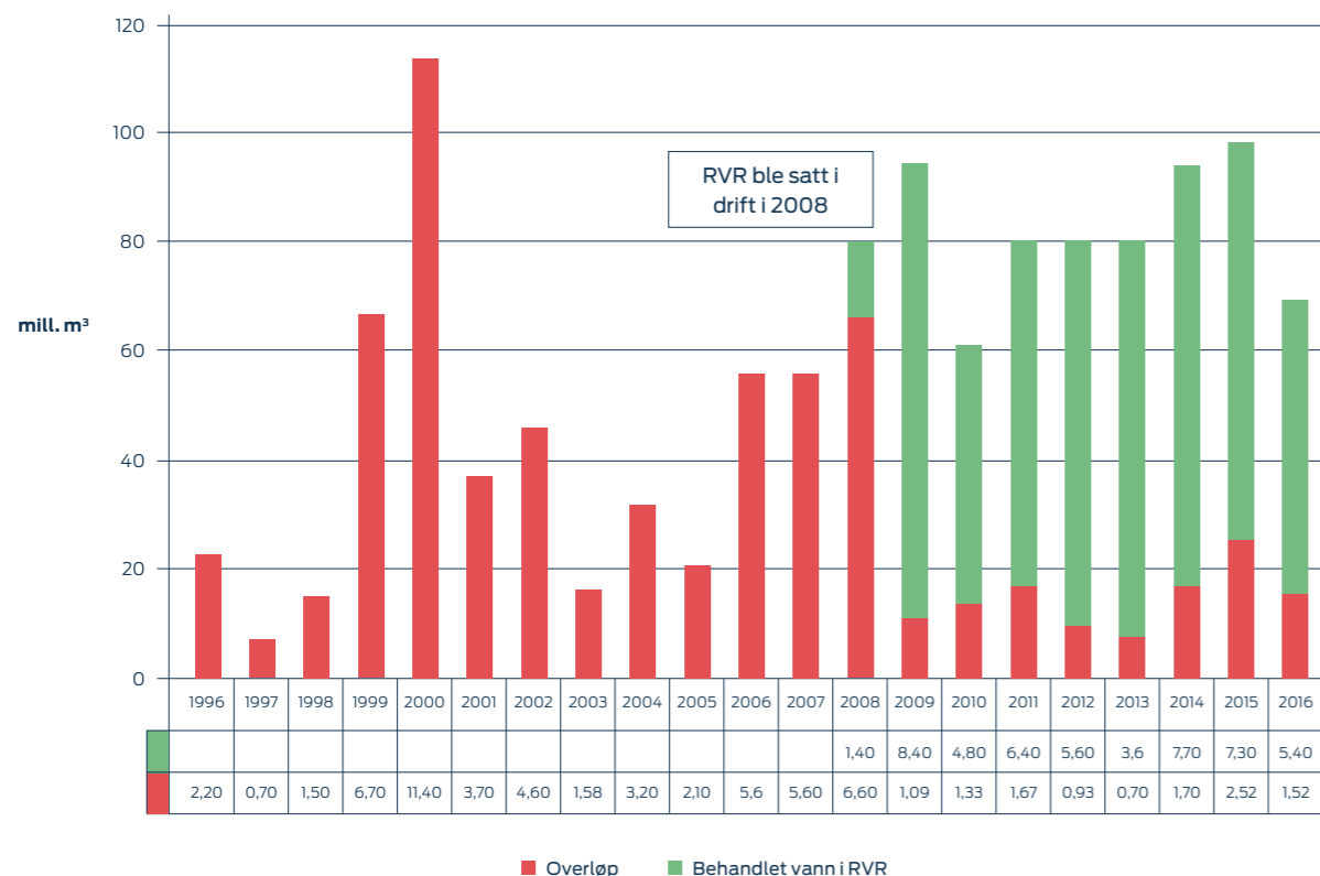
Figur 3: Behandlet vannmengde i regnvannsanlegg (RVR) og overløp i mill. m 3 per år.
