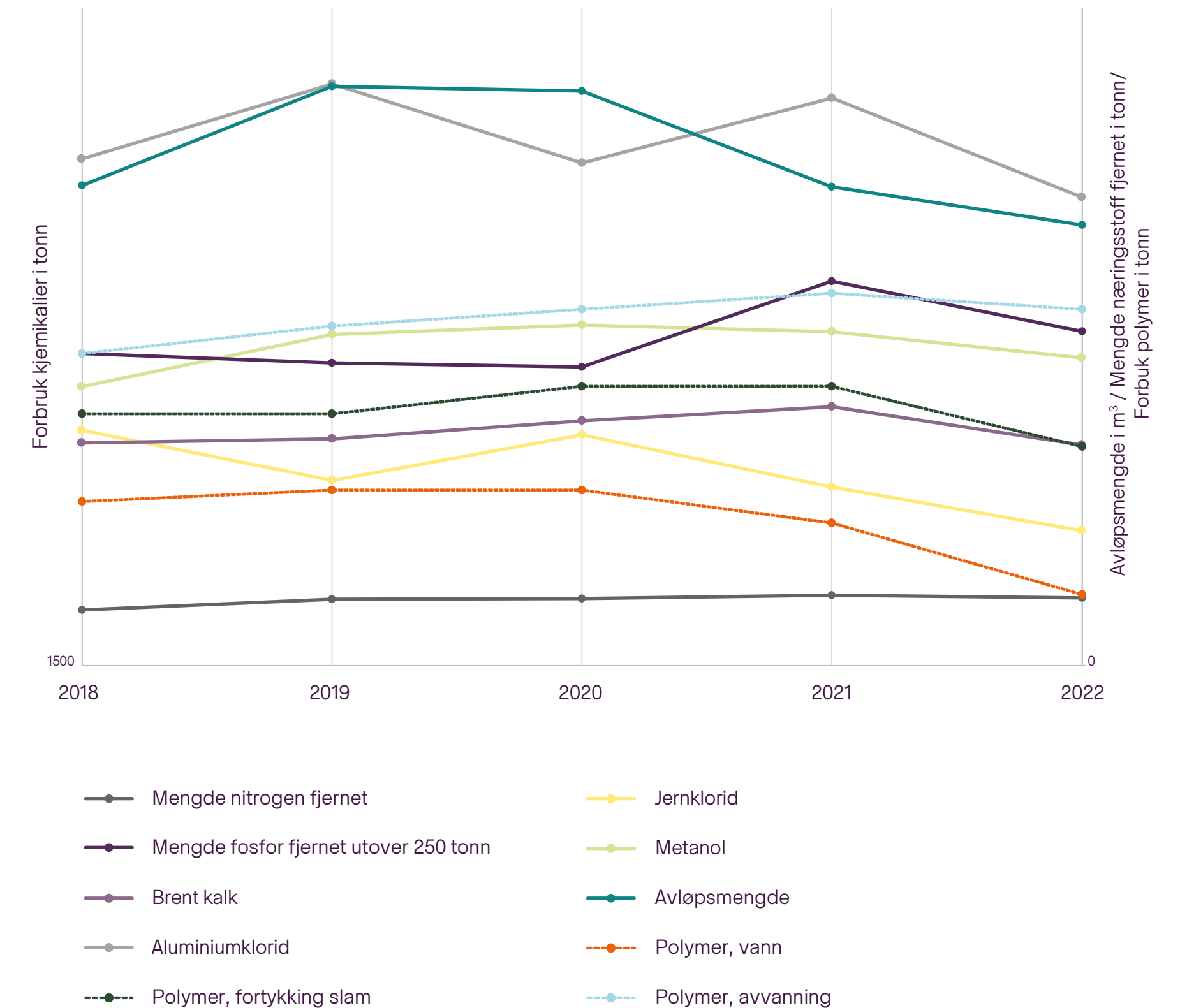
Figur 7. Forbruk av prosesskjemikalier siste fem år sammen med mengde nitrogen fjernet og avløpsmengde
